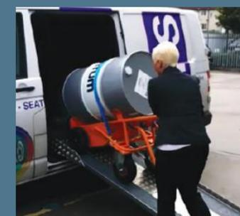
Una leggera rampa a due pezzi specificamente progettata permette di caricare facilmente il carrello carico a bordo di furgoni e camion.
