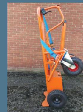
Progettato per spostare velocemente e in sicurezza fusti e bidoni, questo carrello elettrico motorizzato risolve il problema di movimentare questi grossi pesi anche senza grandi macchinari.
